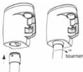
12. Insérer l'embout du boyau dans le boîtier. L'installation est maintenant terminée.
