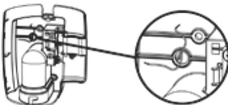
6. Ensuite, fixer la console sur la plaque de fixation avec les trois vis courtes (#10 3/4").
