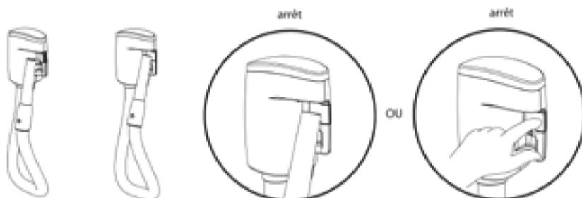
**Note:** Pour assurer l'utilisation en toute sécurité du WallyFlex, il est possible, en tout temps, d'arrêter l'aspirateur central en poussant sur l'interrupteur de démarrage.
