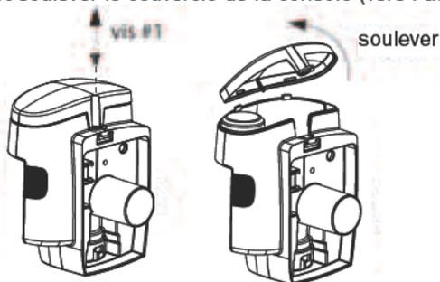
4. Retirer la vis #2 en appuyant légèrement sur le boîtier, en bas à droite. Ouvrir le panneau avant de la console.
