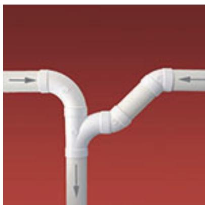
La jonction de deux branches du réseau doit être effectuée en fonction du bon sens. Voici un exemple de ce qu'il peut être fait. D'autres solutions sont possibles
