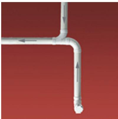
Ce montage est très fréquent lorsque l'on veut raccorder le réseau à la centrale en y joignant une prise de service. L'exemple ci-dessus vous indique comment positionner la dérivation sans la mettre à l'envers tout en évitant les ennuis de l'assemblage ci-contre.
