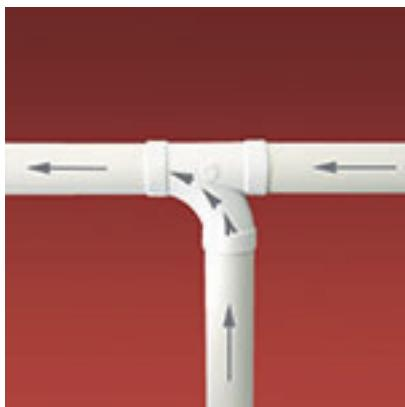
Les raccords de dérivation doivent toujours être orientés dans le sens du flux.
